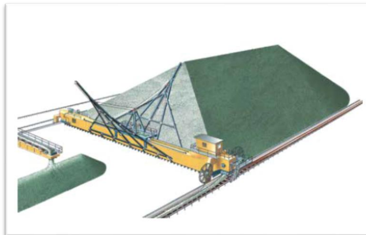
Figura 2.4. Reclamador de acción frontal. (Fuente: Stacker and Reclaimer systems for cement plants, FL Smidth).
