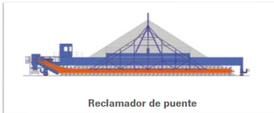
Figura 2.3. Reclamador de acción frontal. (Fuente: Parques de almacenamiento Technik, Claudius Peters).
