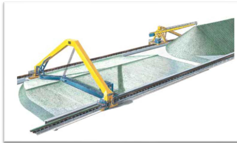
Figura 2.5. Reclamador de acción lateral de dos brazos. (Fuente Stacker and reclaimer systems for cement plants , FL Smidth).
