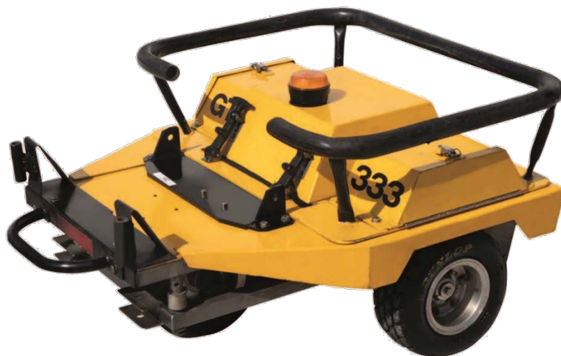
Figura 10. Grip tester propiedad de LanammeUCR
