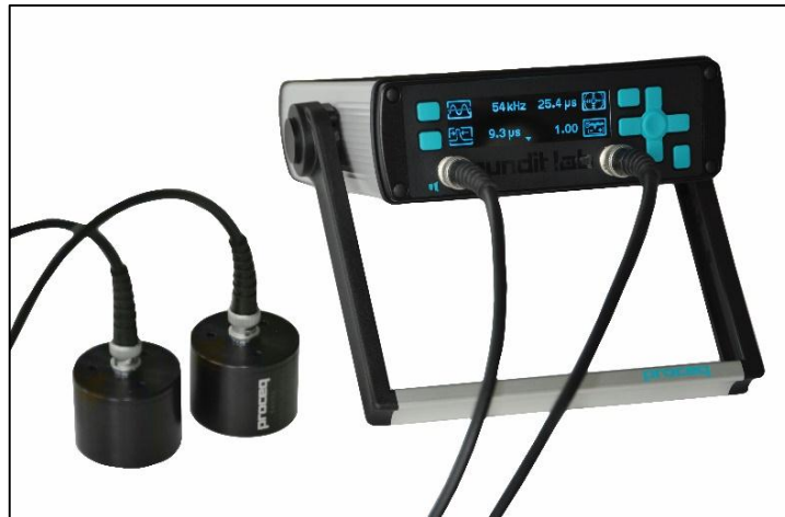
Figura 7. Medidor de velocidad de onda Pundit Lab
