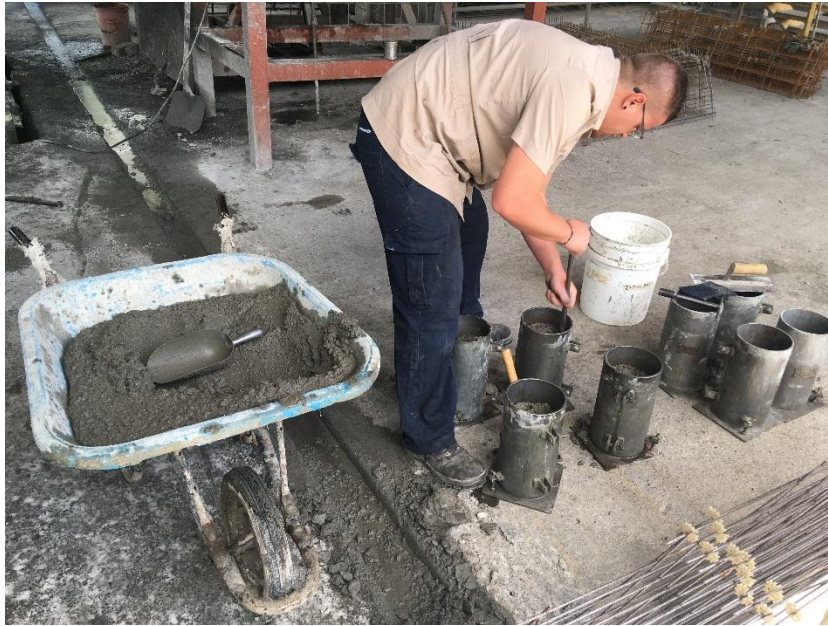
Figura 13. Proceso de confección de cilindros de control.
