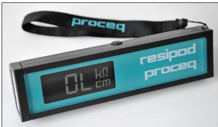
Figura 5. Medidor de resistividad resipod
