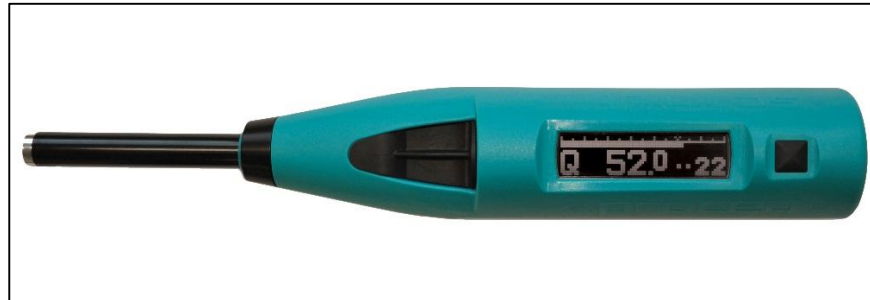
Figura 4. Esclerómetro Silverschmidt tipo L
