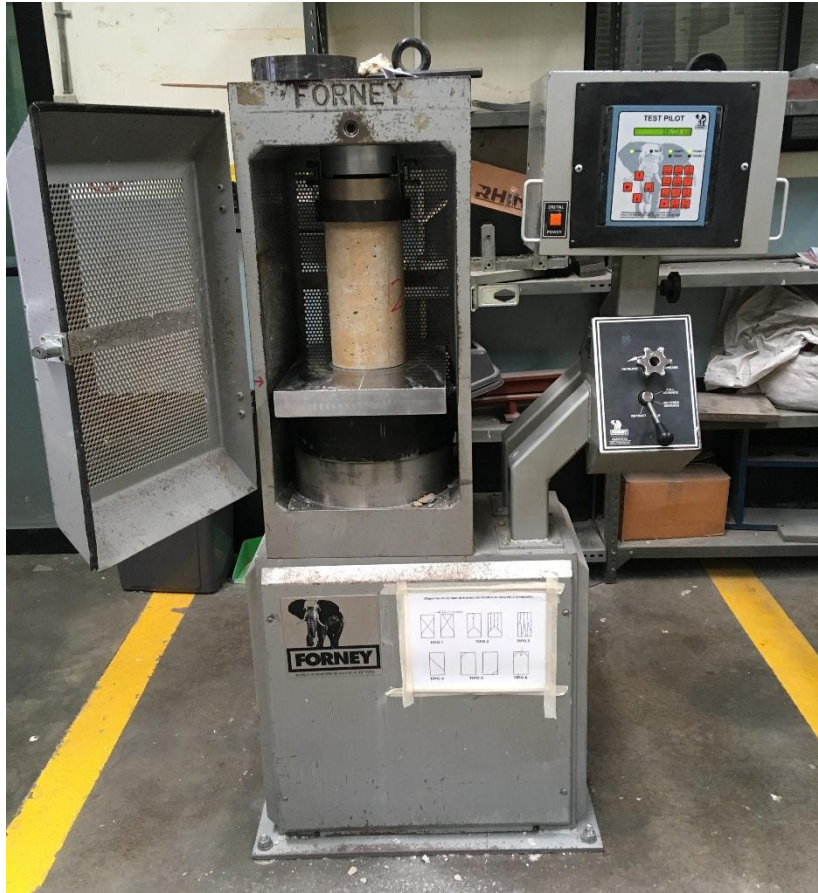
Figura 19. Máquina de compresión propiedad del LanammeUCR
