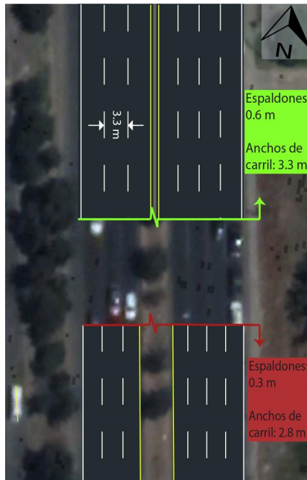
Figura 68. Diagrama de geometría propuesta vs condición actual
