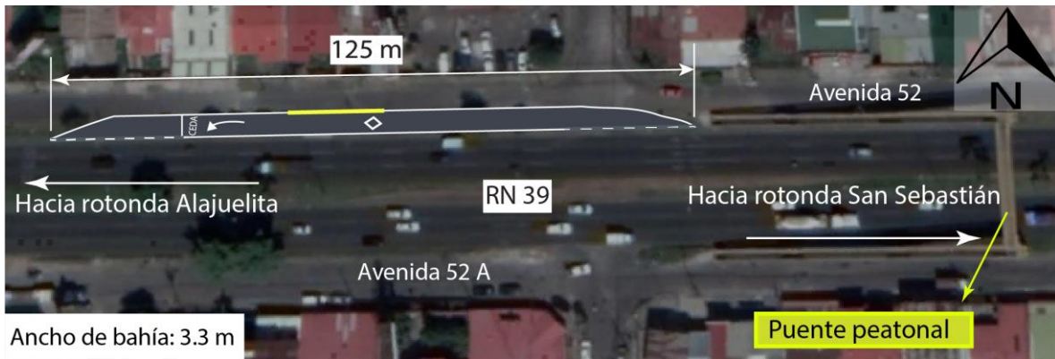
Figura 20. Esquema y dimensionamiento de bahía de bus propuesta
