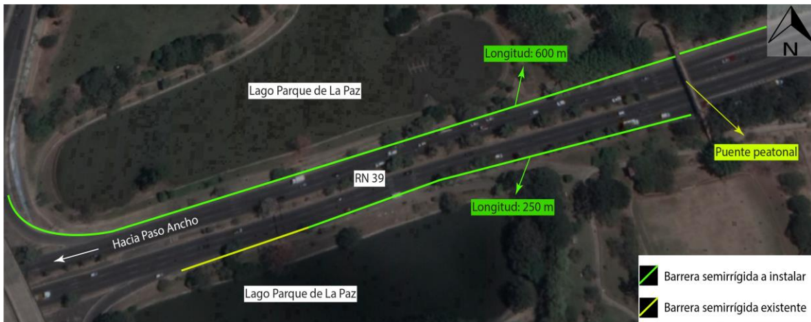
Figura 84. Localización y especificación de barreras tramo M-Ñ
