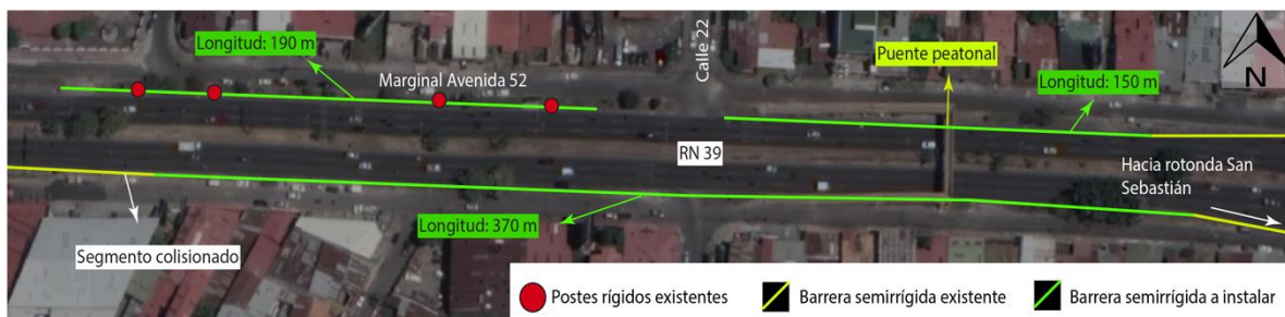
Figura 81. Localización y especificación de barreras tramo K-L margen sur y norte sector este
