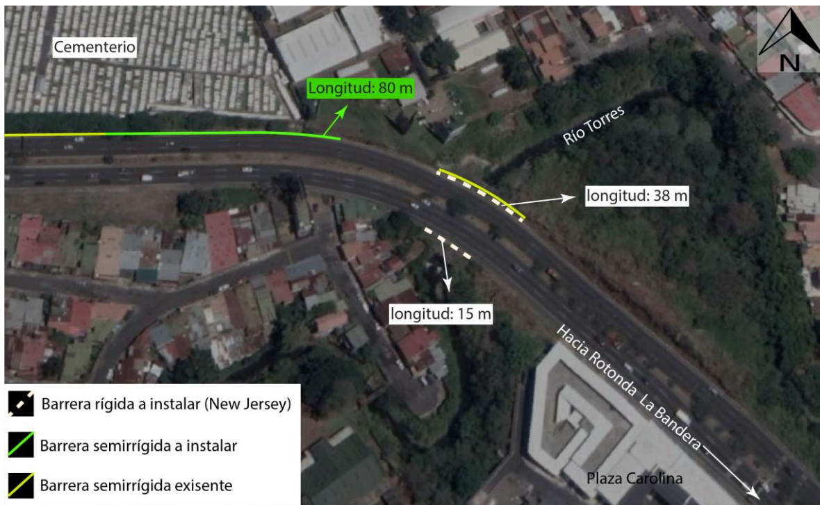
Figura 86. Localización y especificación de barreras tramo S-T
