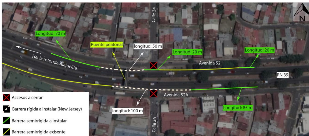
Figura 82. Localización y especificación de barreras tramo K-L margen sur y norte sector oeste
