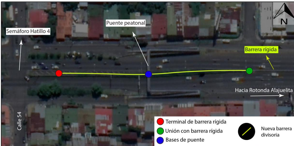
Figura 69. Alineamiento de nueva barrera rígida en mediana
