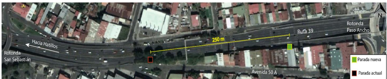
Figura 32. Esquema de reubicación de parada de autobús tramo San Sebastián – Paso Ancho
