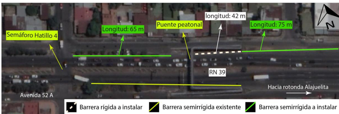
Figura 78. Localización y especificación de barreras tramo J-K
