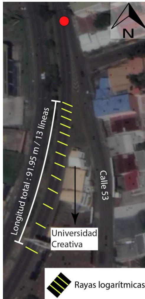
Figura 43. Ubicación específica de rayas logarítmicas sentido sur - norte
