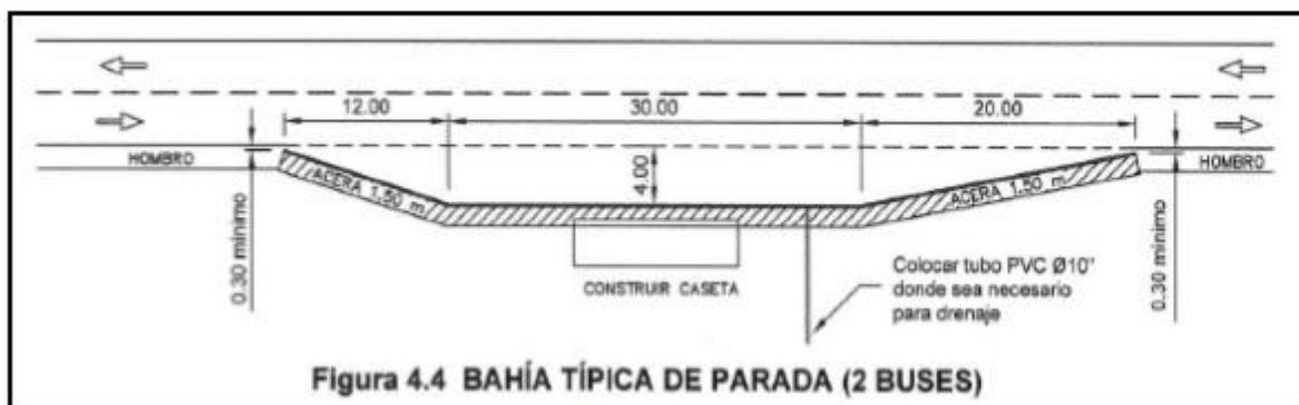
Figura 99. Dimensionamiento recomendado de bahía de autobús
