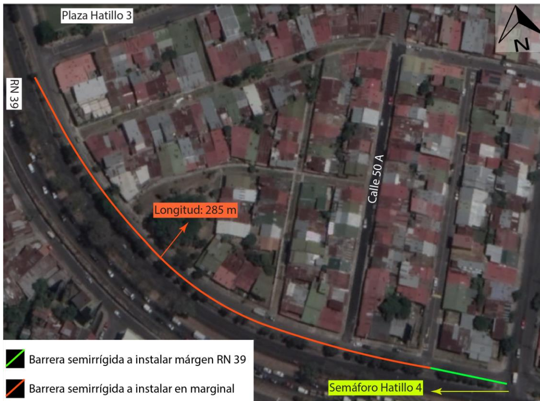
Figura 77. Localización y especificación de barreras sobre marginal tramo I-J
