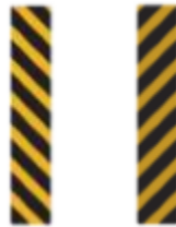
Figura 55. Demarcación alertadora para pilares de puentes
