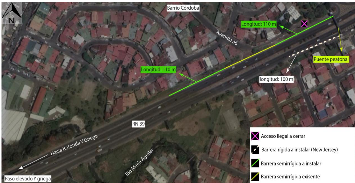
Figura 85. Localización y especificación de barreras tramo Ñ-O
