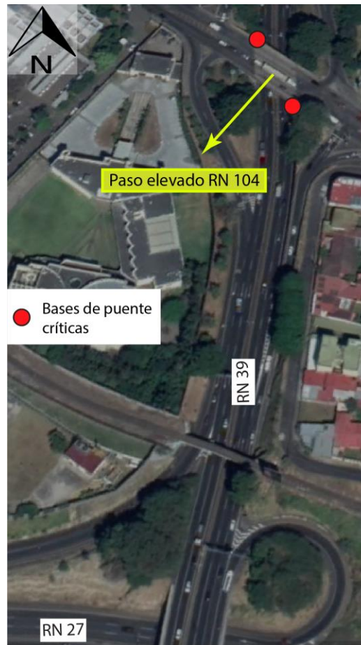
Figura 57. Ubicación de bases paso elevado RN 104
