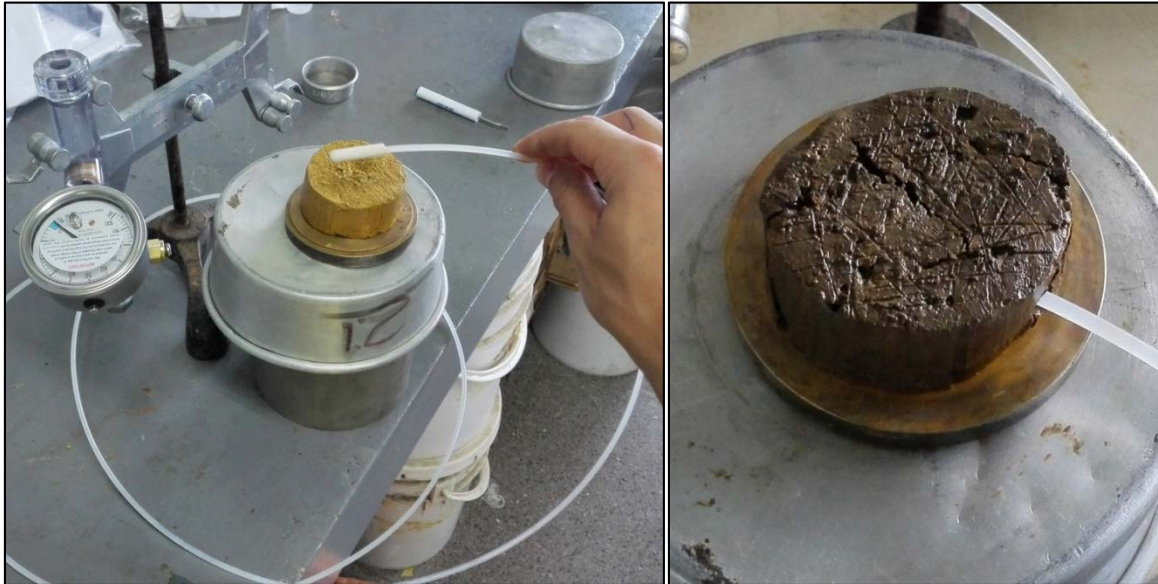
Figura 42. Inserción de la pastilla cerámica en el suelo para determinar la succión matricial.
