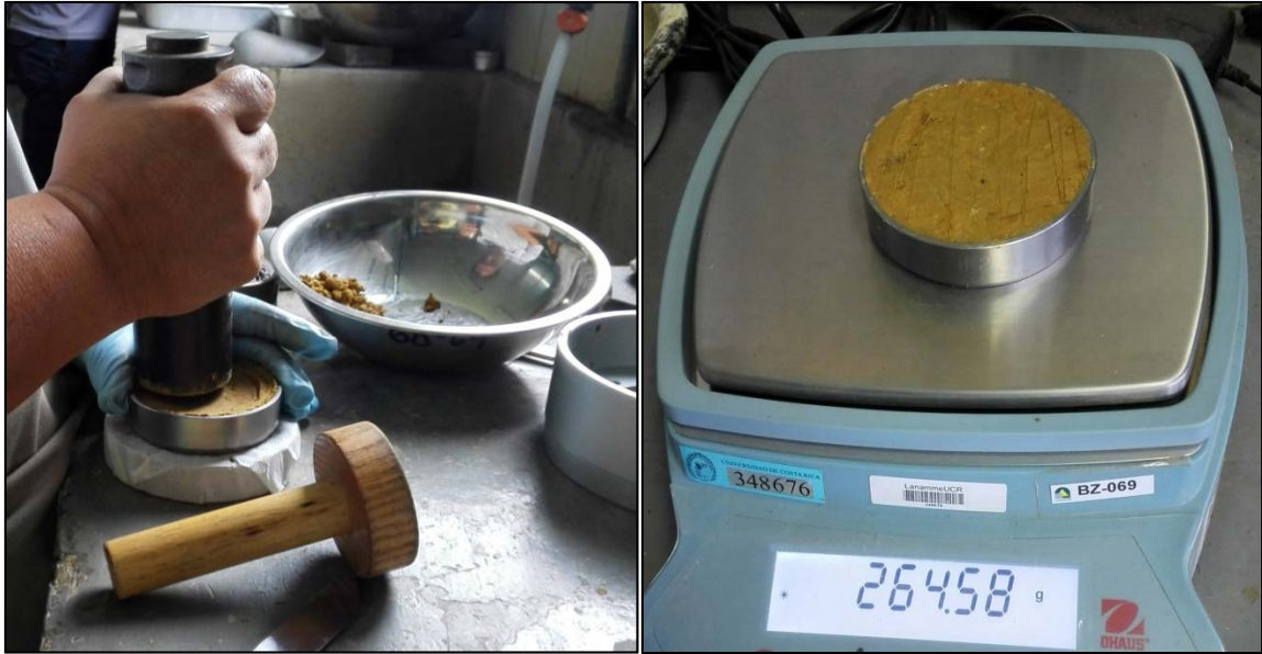
Figura A. 14. Remoldeo y corroboración de la masa del suelo de la muestra para usar en consolidómetro.
