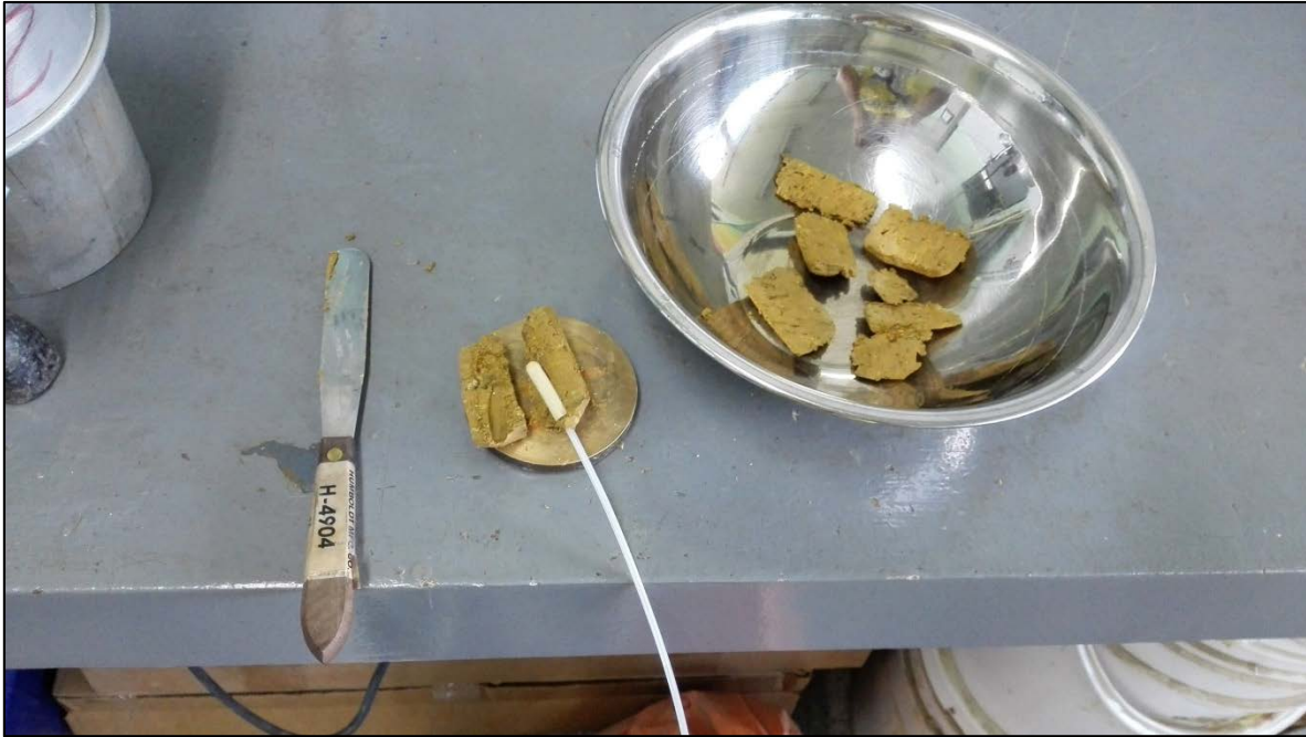
Figura 43. Medición de la humedad para determinar la curva característica suelo-agua.
