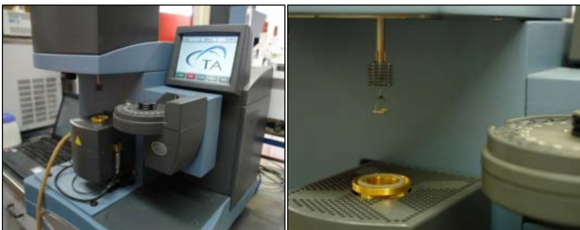
Figura 13. Equipo propiedad del Lanamme para análisis termogravimétrico
