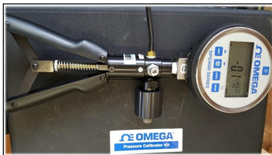
Figura 5.3. Calibrador de peso muerto DPG4000 Marca Omega
