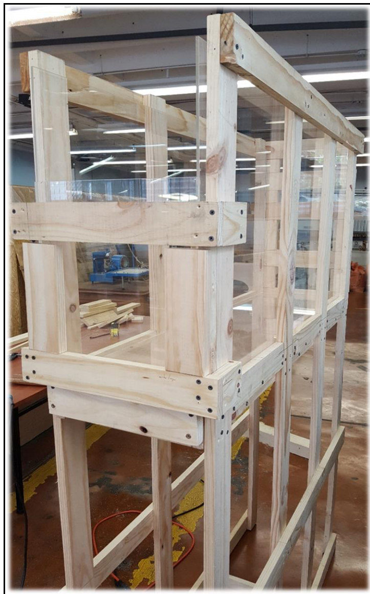
Figura 4.1. Tanque de almacenamiento nuevo en el modelo
