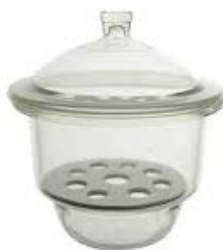
Figura 7. Desecador de vidrio con material desecante sólido \text{CaCl}_2 .
