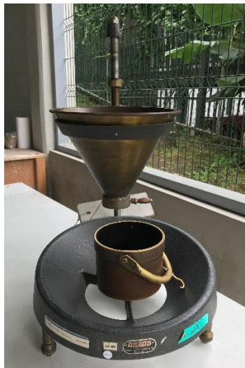
Figura 14. Densímetro, equipo para determinación de densidad aparente.
