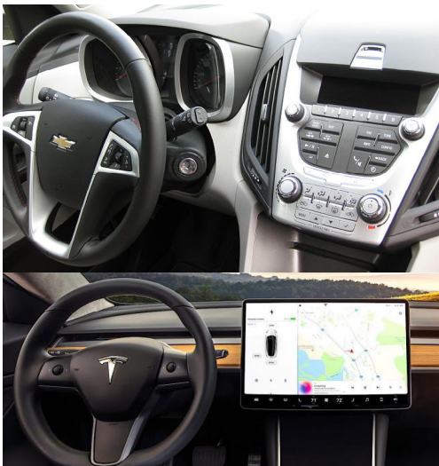
Imagen 55. Tablero análogo de carro Chevrolet (arriba) vs tablero digital de un carro Tesla (abajo).
