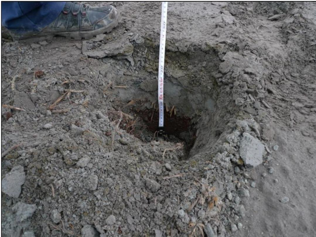
**Figura 19.** Ejemplo de toma de muestra, se observa la profundidad de la excavación de aproximadamente 27 cm, en los anexos de este trabajo se adjuntará un ejemplo de la ficha utilizada para cada muestra.
