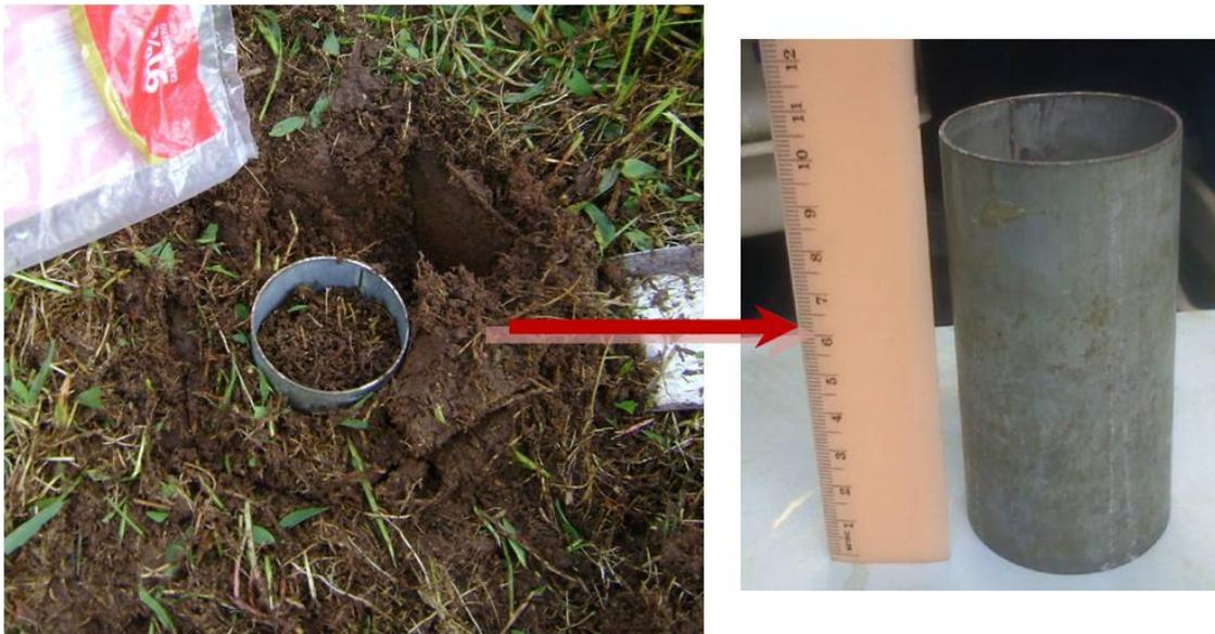
*Fotografía 9. Procedimiento de campo, para extraer la muestra del suelo a través del cilindro, procurando no disturbar la estructura del suelo. Fuente: Arce Anchía, V. (2009)*
