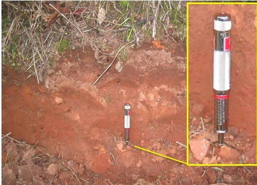
**Fotografía 8.** El penetrómetro es un instrumento para medir el grado de compactación del suelo, lo cual se indica con  $\text{kg/cm}^2$ . Fuente: Arce Anchía, V. (2009)
