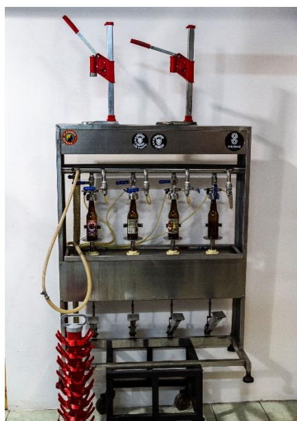
Figura 13: Maquina de embotellado.
