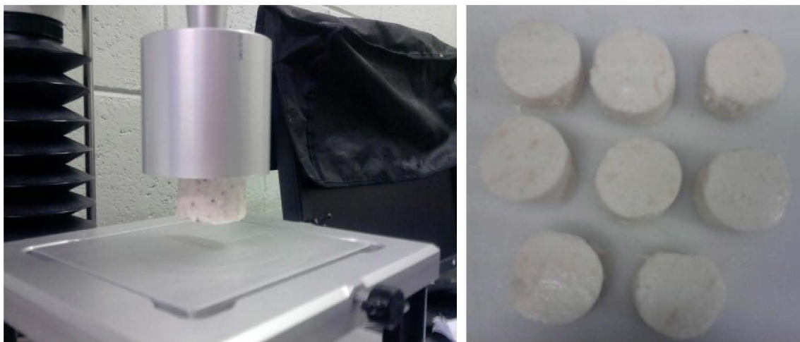
Figura 12. Análisis de perfil de textura de los geles cárnicos sustituidos con harina de plátano ( Musa AAB Horn Plantain Cv. Harton ) verde con cáscara
