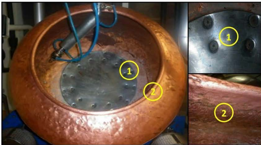
Figura 6. Superficies seleccionadas para el muestreo en la determinación de alérgenos de maní en la línea de grageados.
