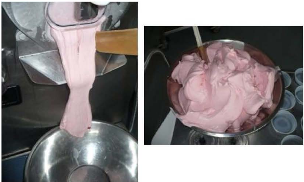
Figura C4. Consistencia "soft serve" alcanzada una vez finalizado el aireamiento de la mixtura.
