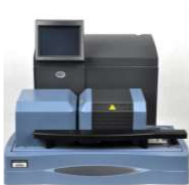
Figura 6.12. Equipo usado para el análisis termogravimétrico (Artisan Technology Group).
