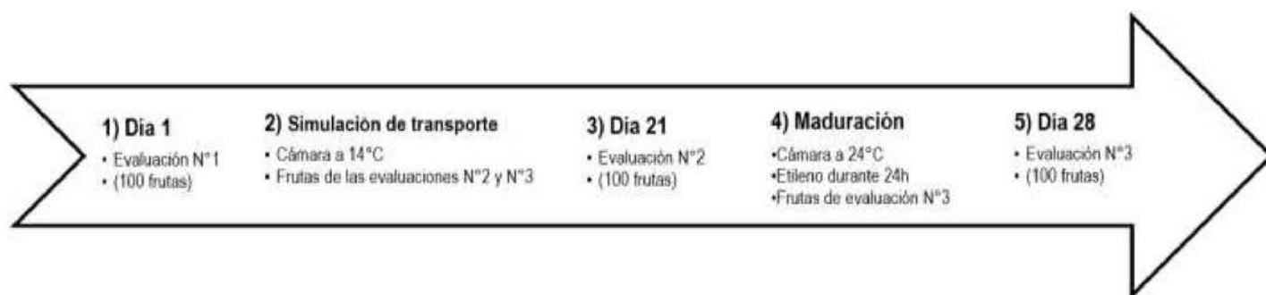
Figura 1. Resumen del proceso ejecutado para los ensayos de banana: principales etapas y características.
