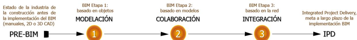
Figura 19. Diagrama de flujo de las etapas de capacidad BIM
