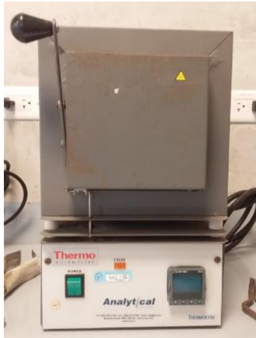
Figura 20. Mufla utilizada para la obtención de los sólidos fijos de la marca Analytical.
