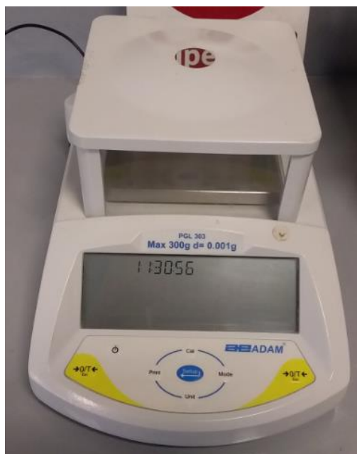
Figura 19. Balanza de precisión para medición de los pesos de los sólidos de la marca ADAM
