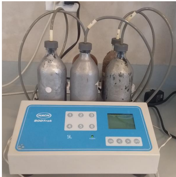
Figura 12. Equipo de medición de DBO marca HACH
