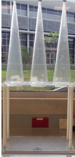
Figura 21. Conos Imhoff utilizados para la medición de sólidos sedimentables y velocidad de sedimentación.
