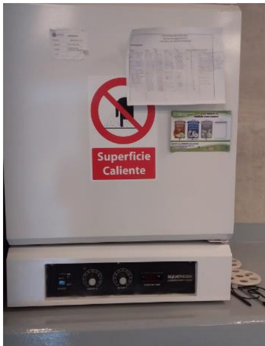
Figura 18. Horno de secado de sólidos de la marca EQUATHERM.
