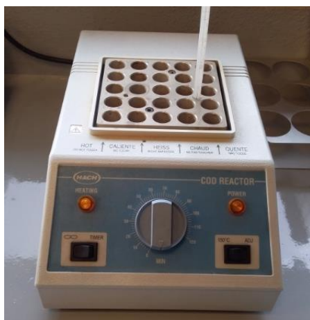
Figura 15. Digestor de DQO utilizado para la realización de las pruebas.
