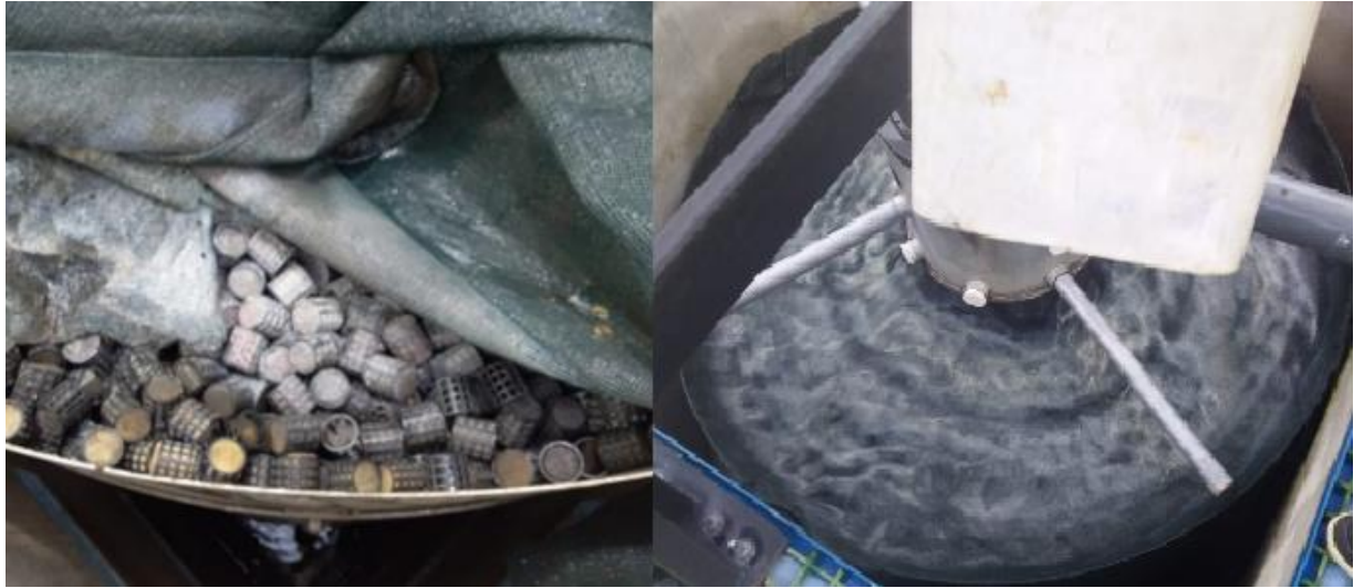
Figura 48. Zona superior del filtro después del cambio del material de soporte por esponjas.
