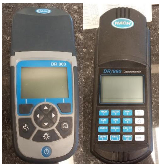
Figura 17. Colorímetros HACH implementados para la medición de los valores.
