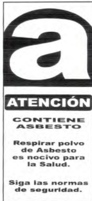
Figura 6. Rotulación para bolsas con desechos que contengan asbesto
