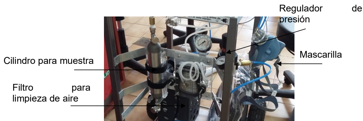
Figura 2. Equipo dimensionado y algunas de sus partes, vista frontal.
