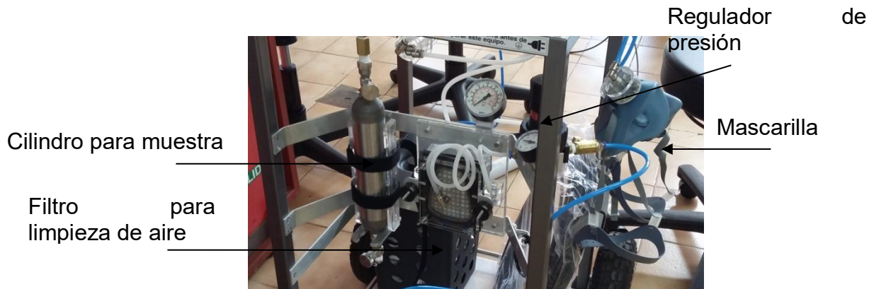
Figura 4.2. Equipo dimensionado y algunas de sus partes, vista frontal.
