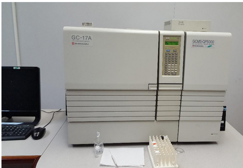
Figura 10. Cromatógrafo de gases acoplado a espectrometría de masas, marca SHIMADZU CORPORATION de la Unidad Analítica de CIPRONA, donde se analizó el aceite esencial de citronela.
