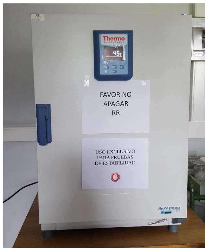
Figura 13. Estufa de convección para pruebas de estabilidad a 45 °C marca Thermo Scientific.
