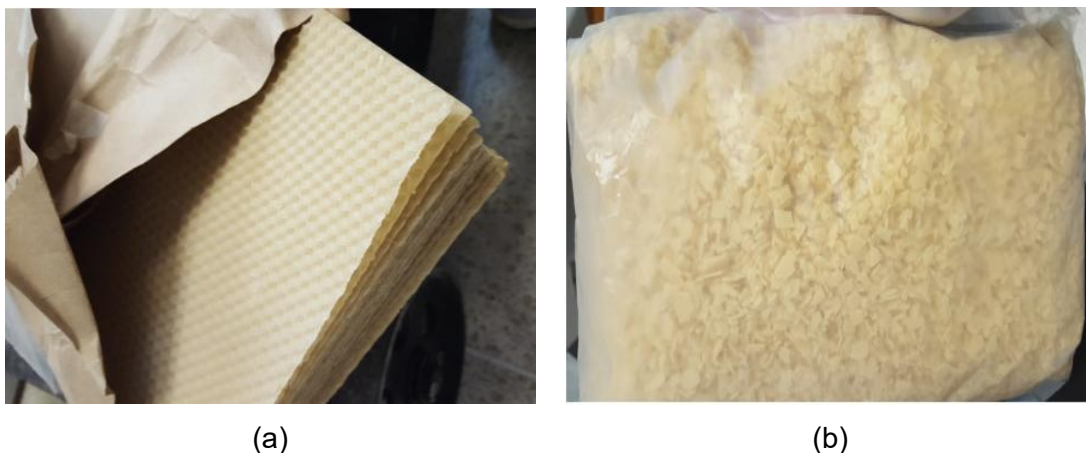
Figura 14. Ceras utilizadas como materia prima para productos de limpieza (a) láminas de cera de abeja, (b) cera carnauba empacada.
