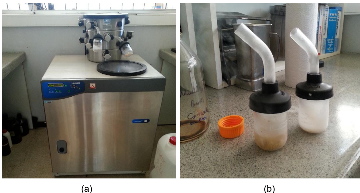
Figura 15. Liofilizador marca Labconco, número de catálogo 77544040 utilizado para eliminar la humedad de las ceras (a), envases con cera carnauba y cera de abeja congelados con nitrógeno para su liofilización (b).
