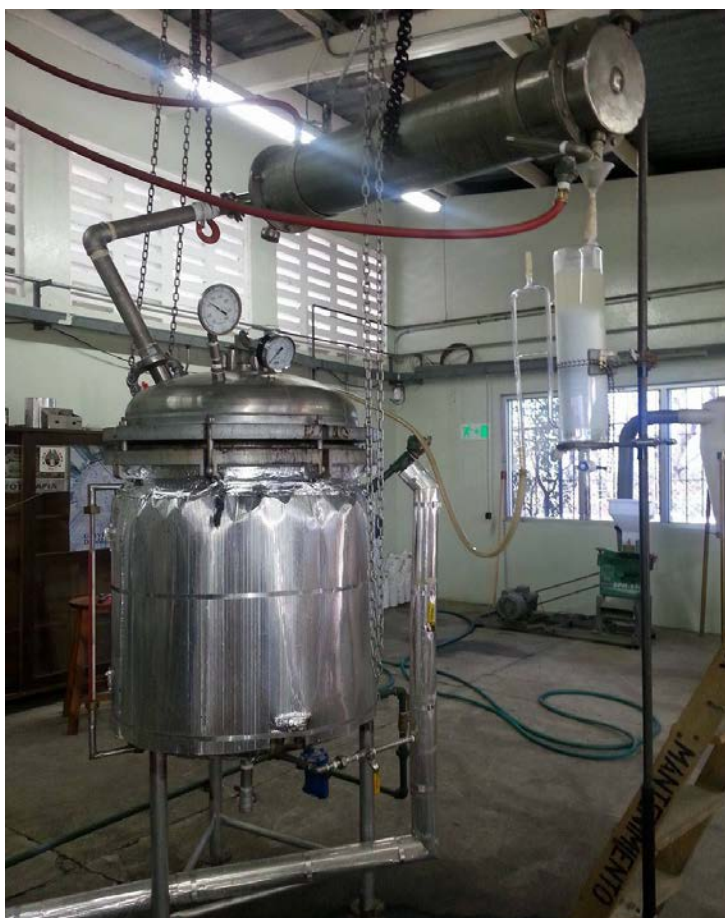
Figura 9. Destilador de la planta piloto con sus principales equipos: condensador y florentino.
