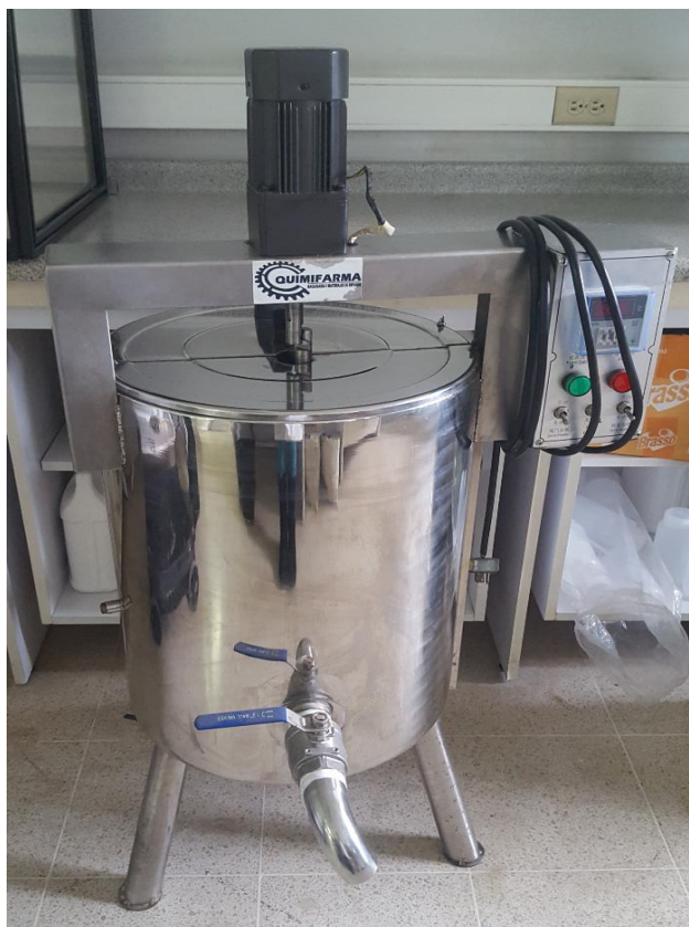
Figura 32. Marmita del laboratorio de tecnología química del CIPRONA.
