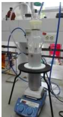
Figura 3.28. Fotoreactor utilizado durante la producción del catalizador con platino.
