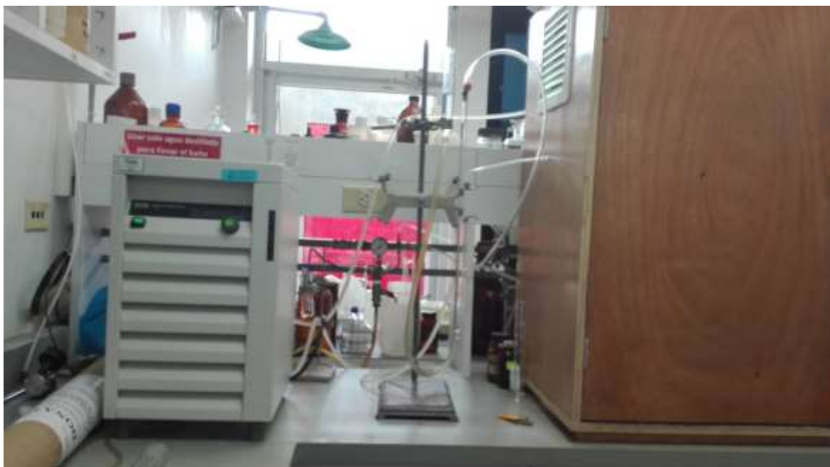
Figura 5.14. Esquema de reacción: chiller, sistema de regulación de presión y gabinete (de izquierda a derecha).
