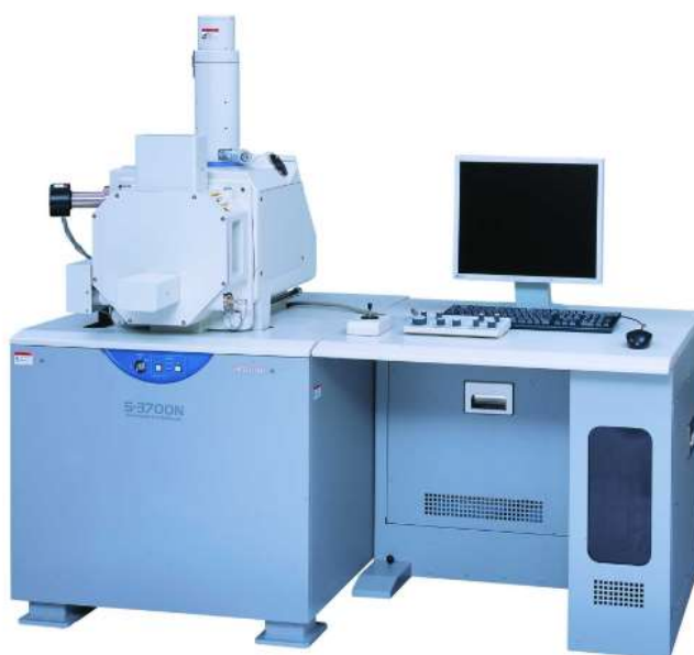
Figura 3.29. Microscopio electrónico de barrido utilizado para determinar porcentaje de platino en el catalizador (Hitachi, 2016).
