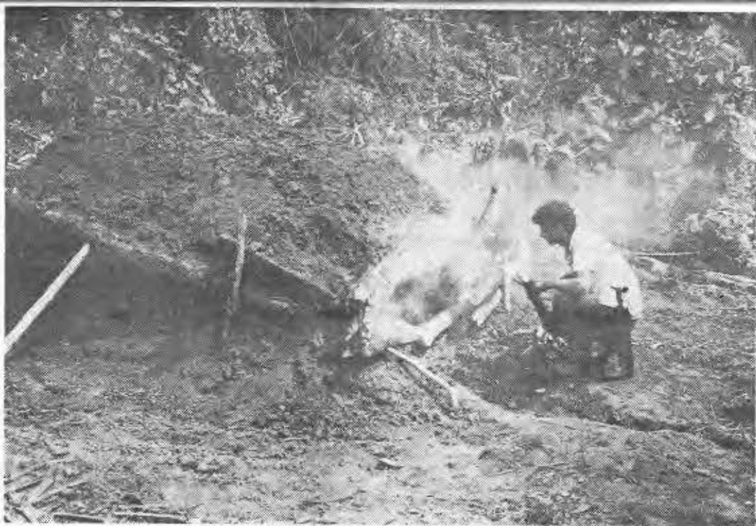
Concluida la carbonera, se procede a encender la leña por el orificio del frente. Se le deja un respiradero por detrás para que la quema sea pareja. Una carbonera corriente tarda entre ocho y diez días para estar debidamente quemada y lista para ser ENSACADA.
