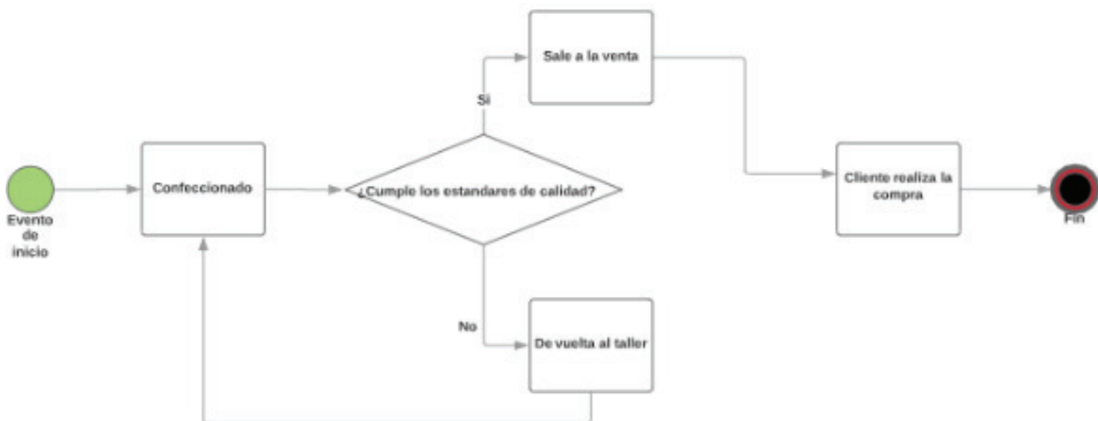
Figura 24. Diagrama de flujo para el proceso de control de calidad en la fabricación de productos BM.
