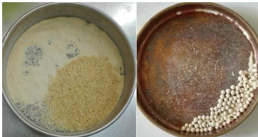
Figura 11. Izquierda: Tamiz N°18 (Apertura de 1001 \mu\text{m} ) obstruido con partículas finas. Derecha: Plato con aglomeración de partículas, menores al tamiz 80 ( D_p \leq 178 \mu\text{m} ).
