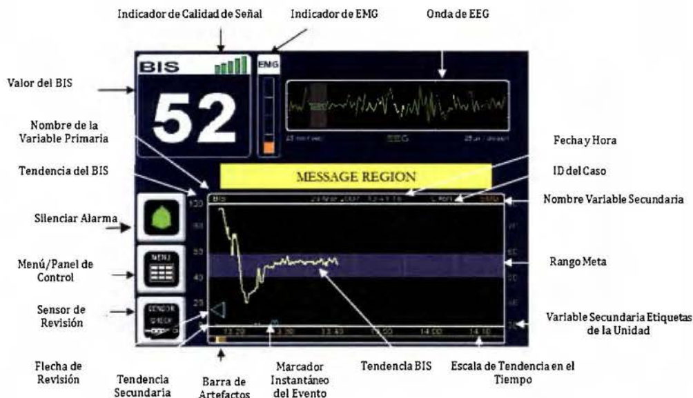
Figura 2. Parámetros obtenidos del monitor BIS VISTA. (Fotografía cedida por Aspect Medical System™)
