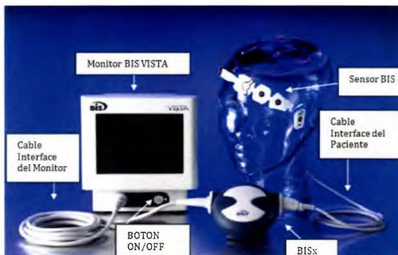
Figura 1. Componentes del monitor BIS VISTA. (Fotografía cedida por Aspect Medical System™)
