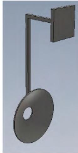
Figura 3.11: Jet ó deflector cóncavo a la entrada del separador. Fuente: Elaboración propia (2016)
