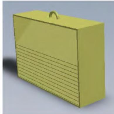
Figura 3.8: Baffles con celosías. Fuente: Elaboración propia (2016)
