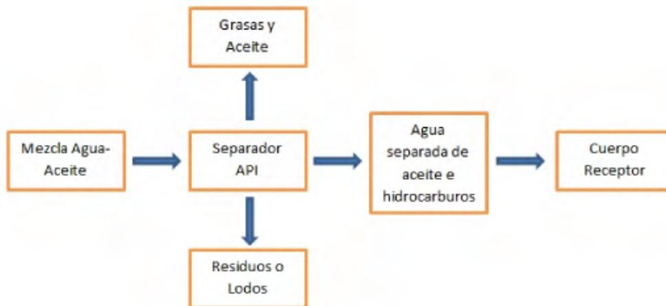
Figura 2.2: Diagrama del proceso de tratamiento de aguas residuales. Fuente: Elaboración propia (2015)
