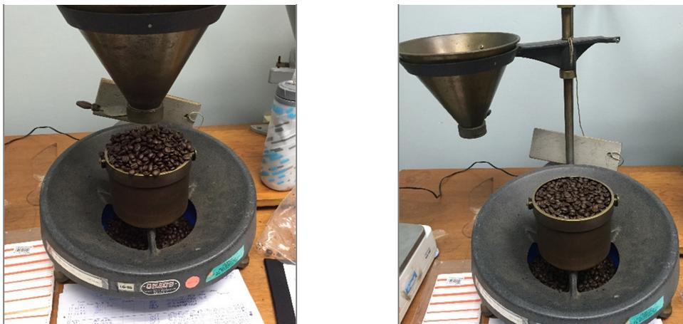
**Figura 2.7.** Densímetro, equipo para medición de densidad aparente
