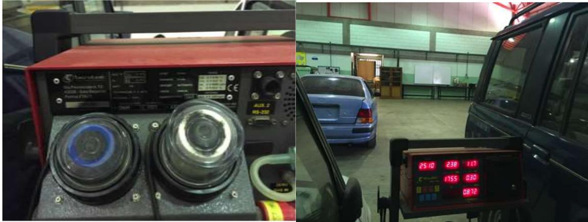
**Figura 3. 7.** Analizador de gases *Tecnotest 488*.
