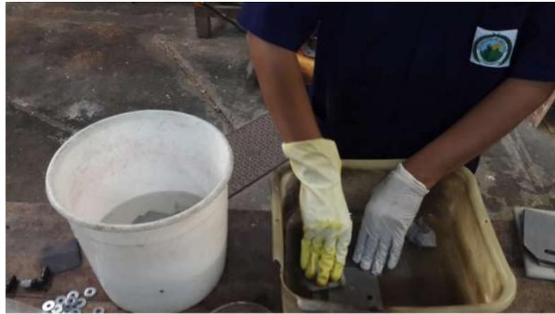
**Figura 2. 6.** Limpieza de placas con ácido acético.
