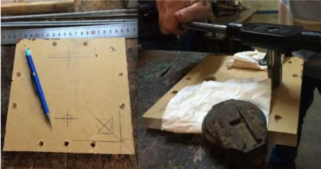
**Figura 2. 11.** Marcado y perforación del acrílico frontal.
