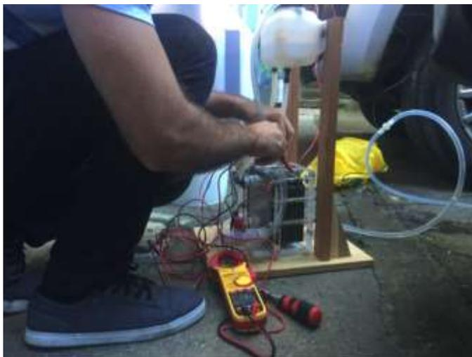
**Figura 3. 1.** Medición de voltaje entre celdas adyacentes.
