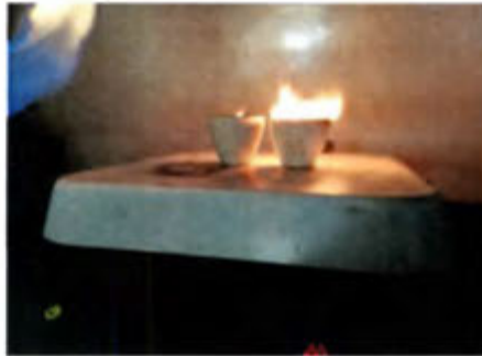
Figura 11. Digestión de muestras de biodiésel para la determinación de las cenizas sulfatadas.
