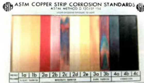
Figura 9. Estándares de comparación ASTM de las tiras de cobre utilizadas en la determinación de corrosividad al cobre.
