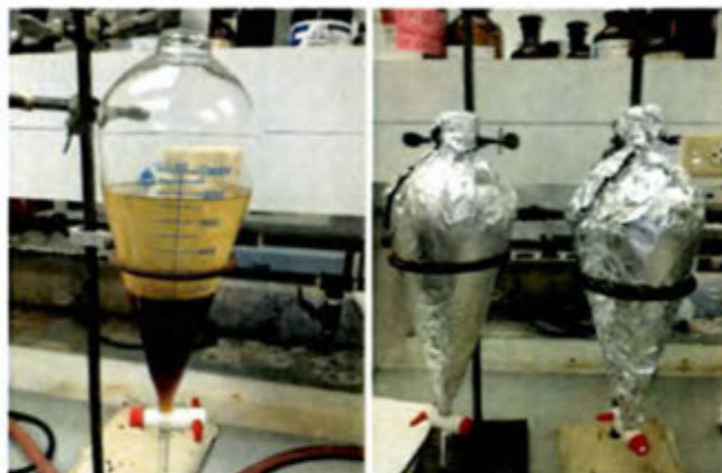
Figura 7. Separación del biodiésel y la glicerina.
