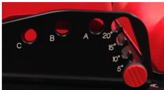
**Figura 6.** Variación en la angulación del soporte de pies de la rampa para extremidades inferiores “Combifix™”
