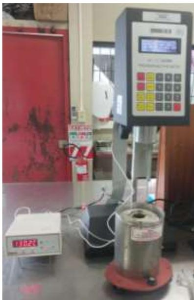
**Figura 5.4** Viscosímetro rotacional y la cámara térmica de temperatura controlada.
