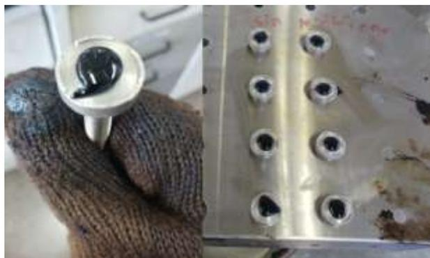
**Figura 5.12** Muestras de asfalto en tornillos metálicos
