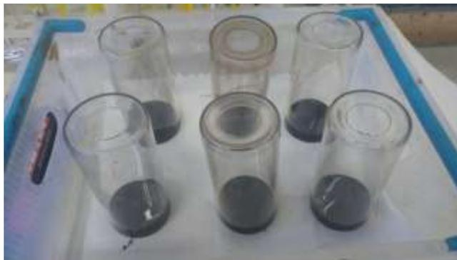
**Figura 5.5** Muestras de asfalto para RTFO
