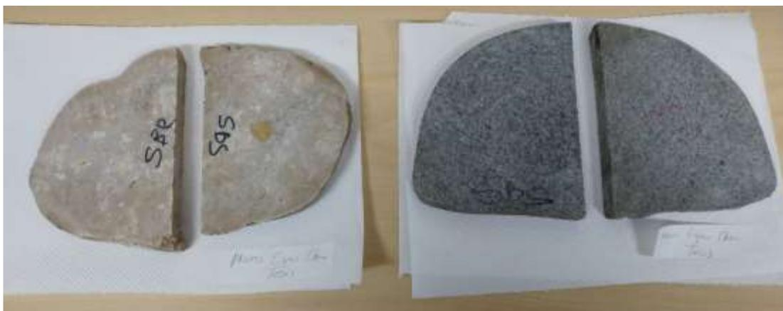
**Figura 5.11** Agregado de piedra tipo caliza y silícica.
