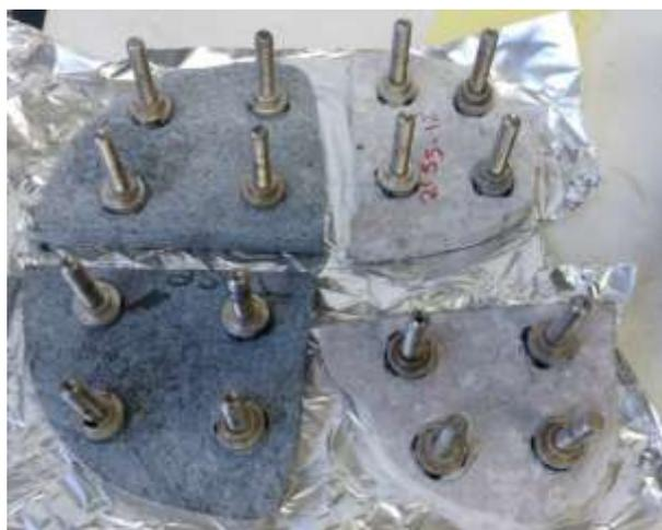
**Figura 5.13** Muestras de asfalto sobre agregados silicio y calizo.
