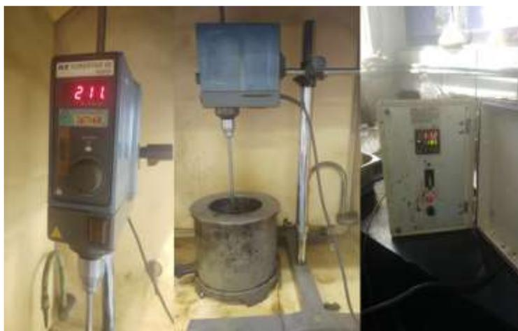
**Figura 5.2** Sistema para la modificación de asfalto.
