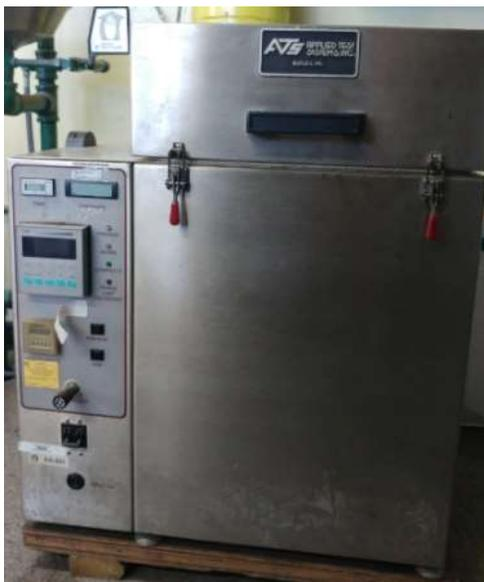
**Figura 5.7** Horno de envejecimiento acelerado a presión – PAV.
