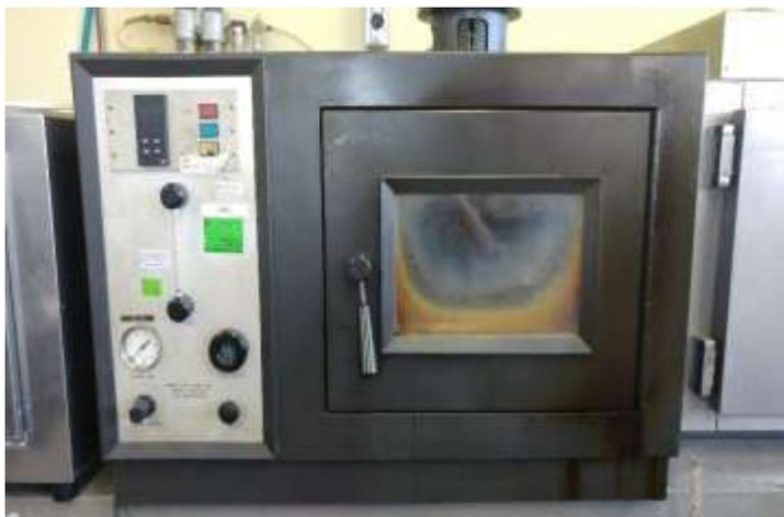
**Figura 5.6** Horno de película delgada rotativa horizontal – RTFO.
