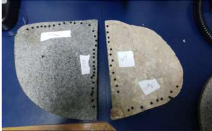
**Figura 5.16** Sistema agregado-asfalto para la medición del ángulo de contacto por goniometría.
