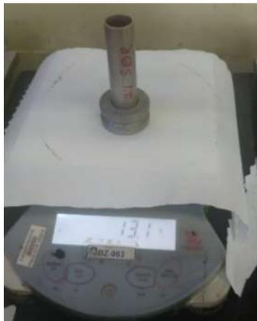
**Figura 5.3** Muestra de asfalto modificado para viscosímetro.
