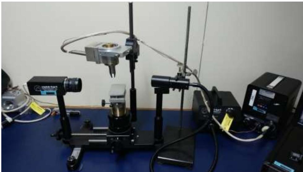
**Figura 5.17** Sistema de medición de ángulo de contacto Goniómetro
