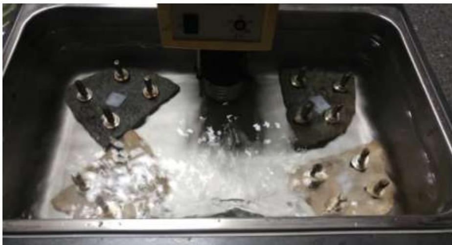
**Figura 5.15** Sistema de acondicionamiento húmedo para ensayo PATTI
