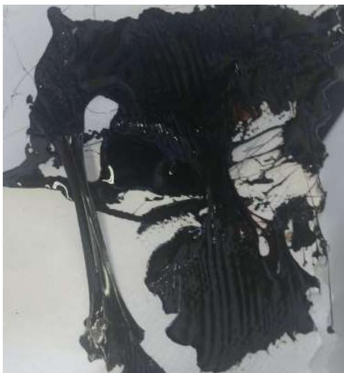
**Figura 6.1** Muestra de asfalto modificado con TER sobre papel toalla
