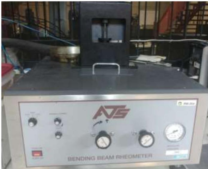
**Figura 5.9** Reómetro de vigas de flexión.
