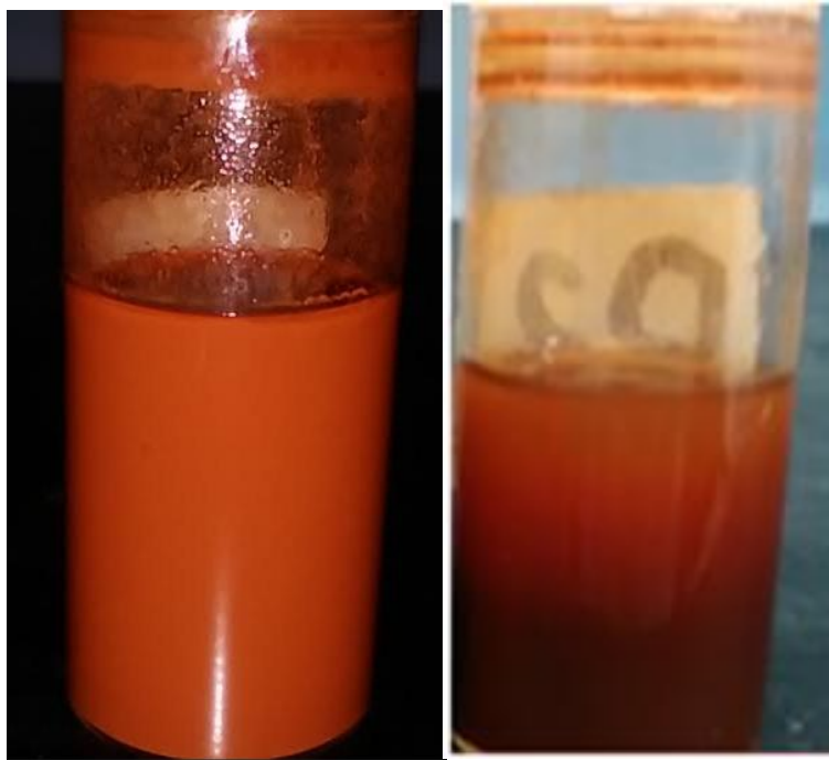
Figura 7: Partículas de Fe_2O_3 formadas por co-precipitación de FeCl_3 con una disolución NH_3 1mol/L
