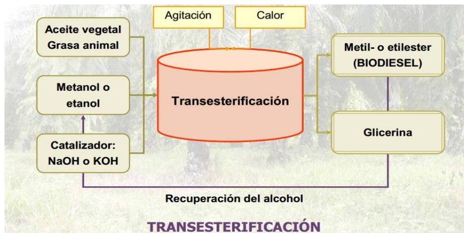
**Figura 2.5.** Esquema de los principales componentes que integran la reacción de transesterificación (Castro, 2014).
