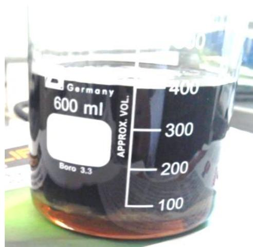
**Figura 8.1.** Fases generadas posterior a la reacción entre el ácido sulfúrico y el aceite usado procedente de Moín (Madrigal, 2015).
