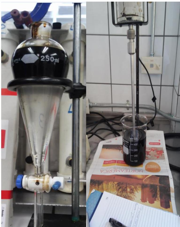
**Figura D.8.** Fotografía de separación de agua libre y de la simulación del reactor.
