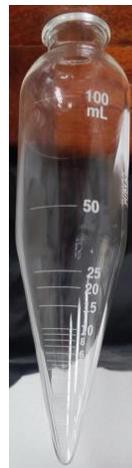
**Figura C.1.** Tubo cónico empleado para medir agua y sedimento empleado conforme ASTM-D1796-11 (Madrigal, 2015).
