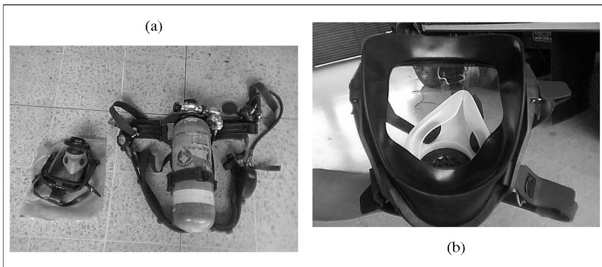
Figura 4.3 A.R.A.C. utilizado por la Unidad de Soporte: (a) equipo completo y (b) detalle de la careta
