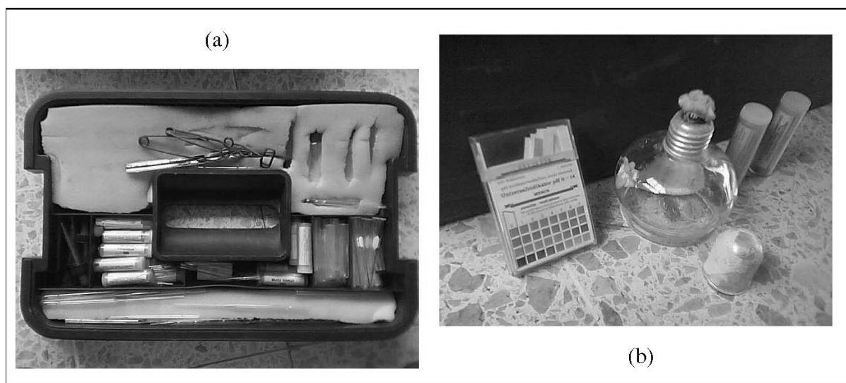
Figura 4.21 Equipo de reactivos: (a) vista superior del maletín, varios indicadores de pH, pinzas y tubos de ensayo para realizar pruebas de identificación y, de izquierda a derecha, (b) indicador de pH universal, mechero y papel tornasol azul y rojo
