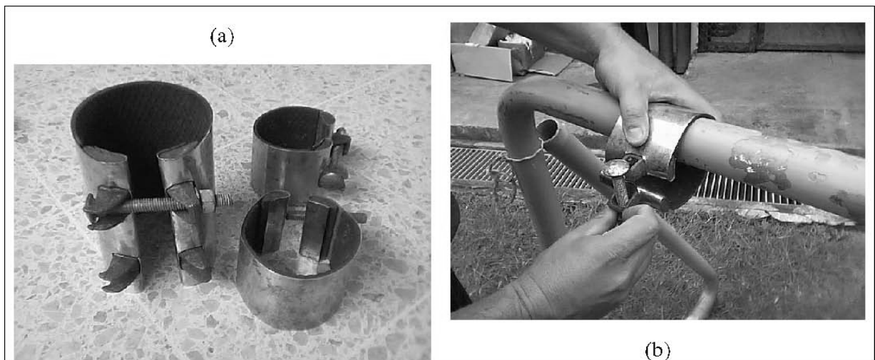
Figura 4.15 (a) Abrazaderas para fugas en tuberías y (b) su modo de uso
