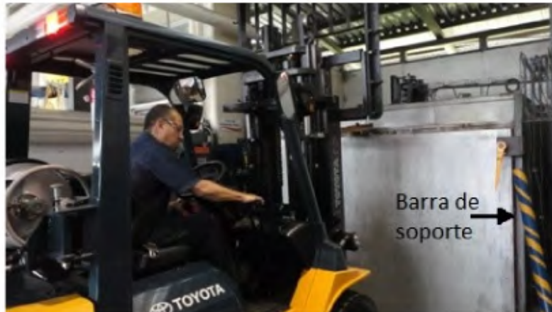
Ilustración 4.27 Apertura de puerta del horno.
