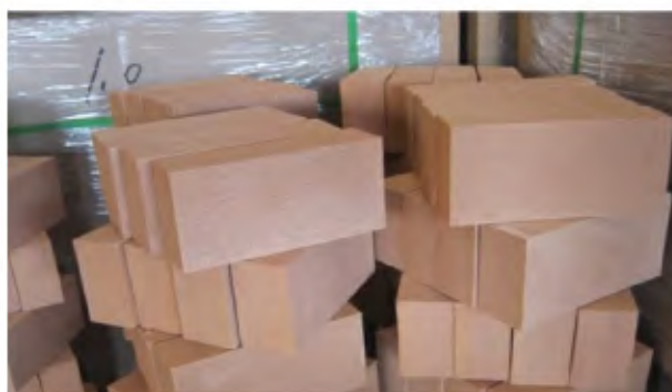
Ilustración 5.45 Ladrillo refractario ThermalCeramics tipo K.
