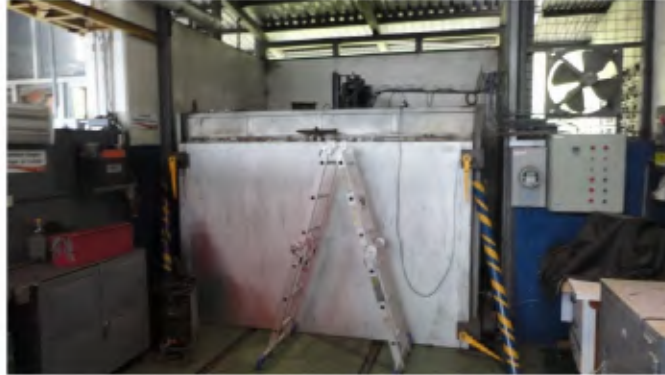
Ilustración 4.29 Horno con puerta completamente cerrada, listo para iniciar el calentamiento.
