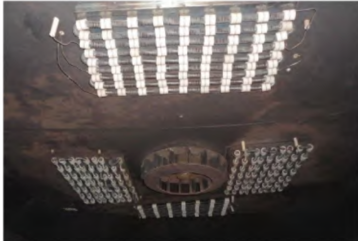
Ilustración 4.41 Resistencias, principal fuente de calor Fuente: Los Autores, 2013
