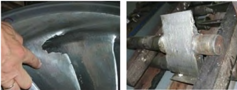
Ilustración 4.24 Apariencia física antes del recargue
