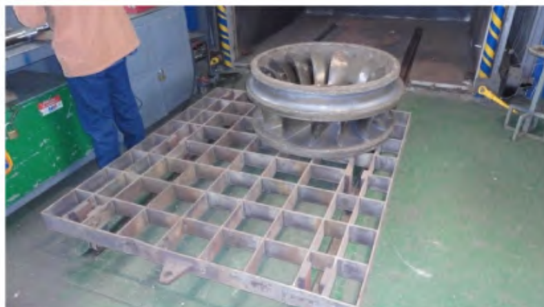
Ilustración 4.28 Rodete listo para ser introducido en el horno.
