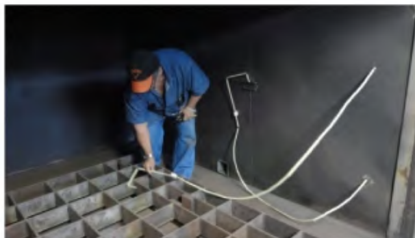
Ilustración 4.30 Colocación de los termopares dentro del horno.
