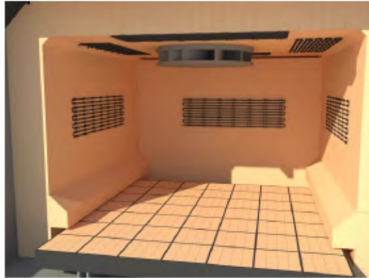
Ilustración 5.49 Vista del hogar y bandeja con los ladrillos moldeados instalados Fuente: Los Autores, 2013.
